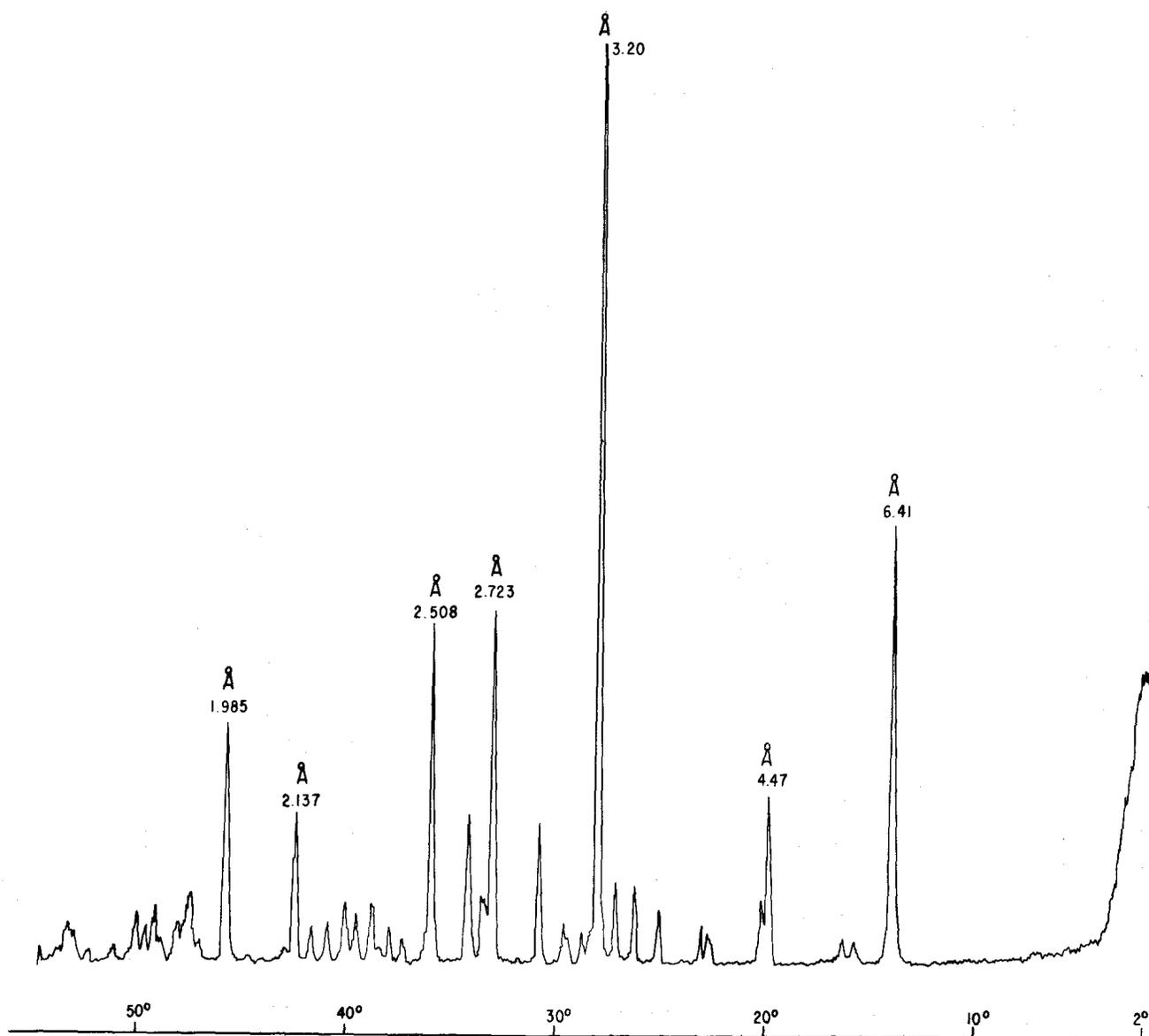
Figura 1.- Difractograma de gaylusita utilizando radiación de cobre.
