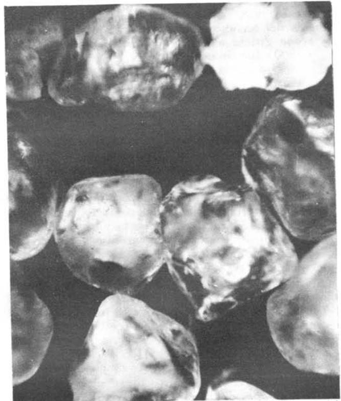
Figura 3.—Fotomicrografía que muestra una menor esfericidad y redondez del cuarzo de la muestra Pa-132, malla + 60, a medida que disminuye el tamaño. X 80.
