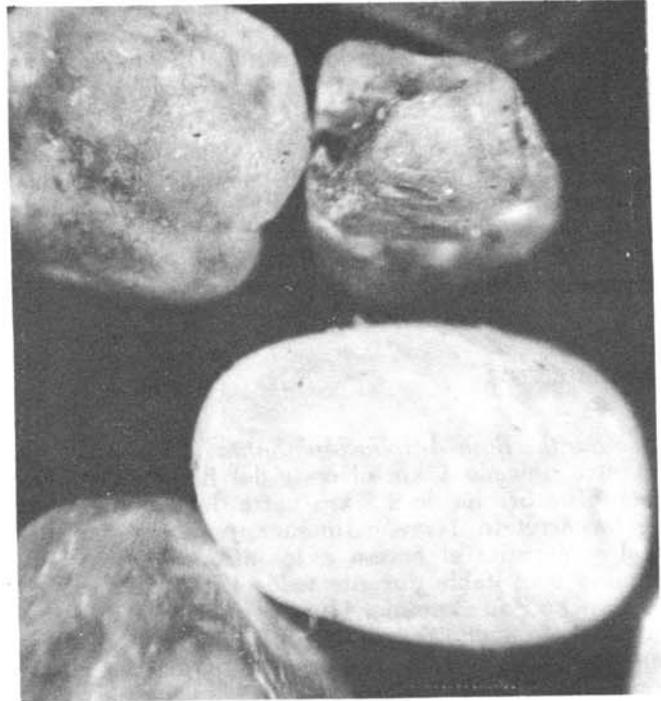
Figura 2.—Fotomicrografía que muestra la redondez y esfericidad de los granos de cuarzo y calcedonia de la muestra Pa-142, malla + 18. Nótese el despulimiento de los granos. X 60.
