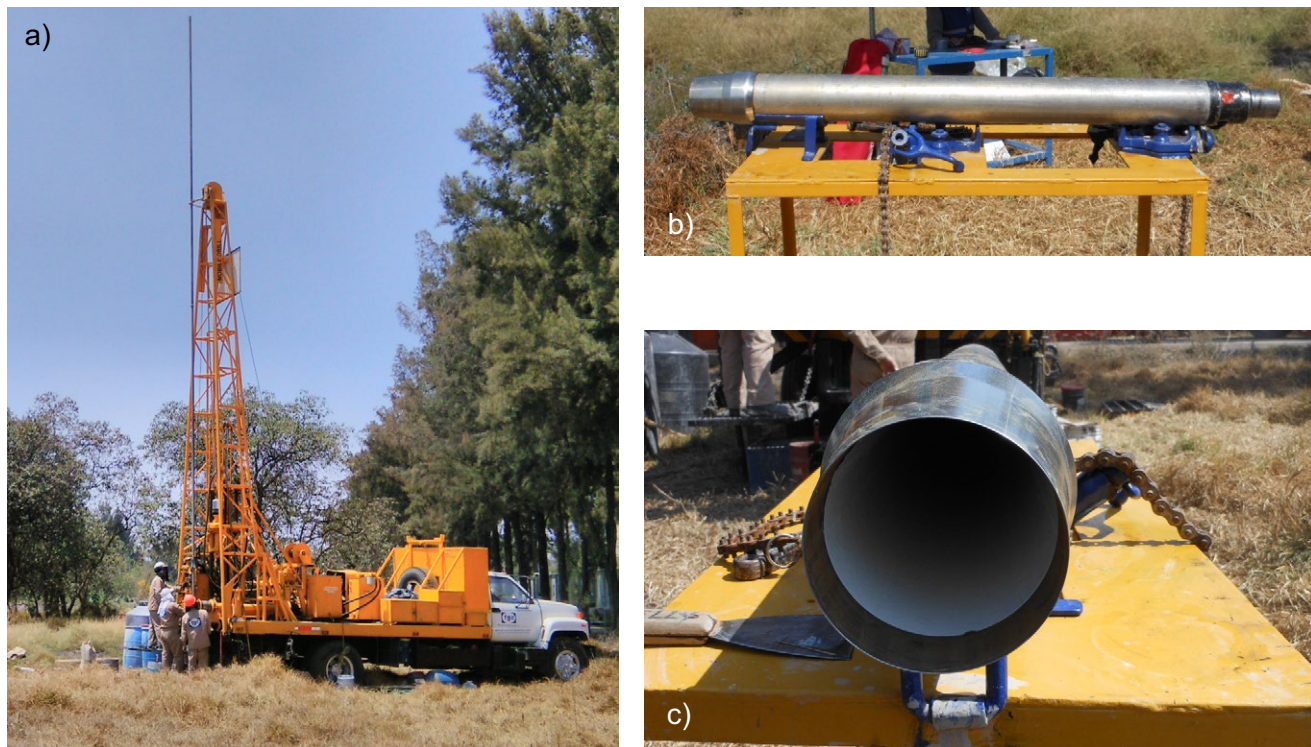
Figura 3. Equipo utilizado en la perforación y colecta de los sedimentos. a) Torre de perforación, b) extractor y tubo TGC, c) detalle del tubo TGC con tubo de PVC en su interior.
